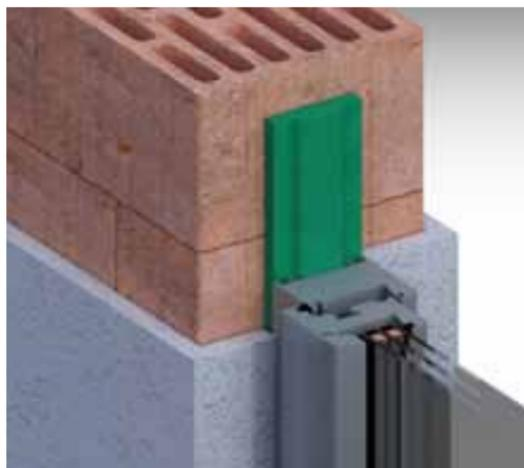
TP654 illmod Trio 1050 je vhodná především na kvalitně připravená rovná ostění jak u novostaveb tak rekonstrukcí. Je nezbytná u pasivních a nízko-energetických domů a dřevostaveb.
