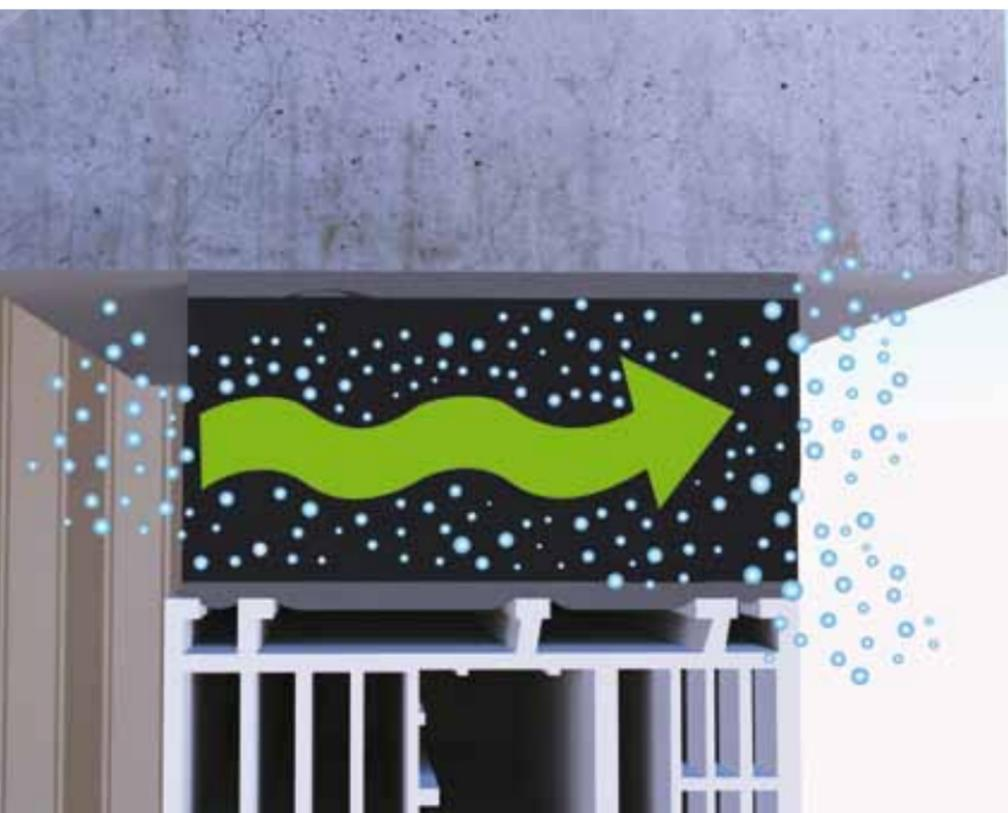
Patentovaná architektura pásky spolu s integrovanou inteligentní membránou řídí propustnost vodních par v závislosti na vlhkosti prostředí. Například v případě vysoké vzdušné vlhkosti v interiéru (viz. obrázek), se buňky membrány otevřou a umožní tak, aby vlhkost odešla ven.
